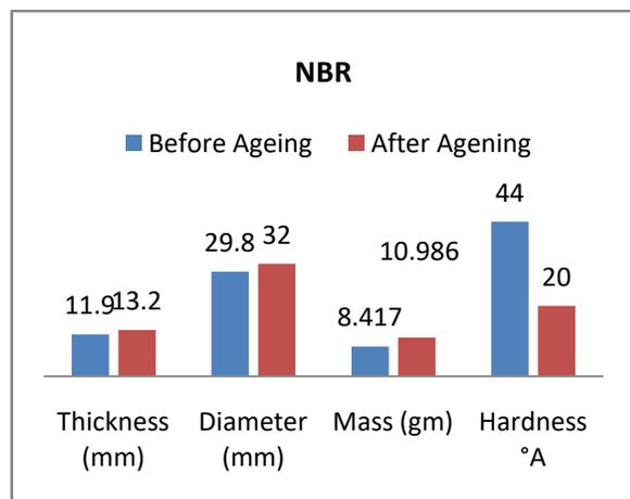
Fig : 6 NBR composite
